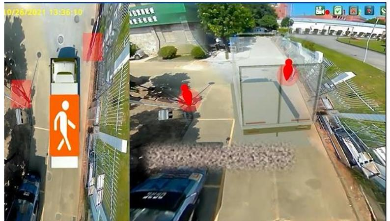
※AIカメラが人を検知して警告音を発します。 ※AIカメラは前後左右どこにでも設置出来ます。
