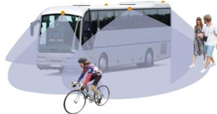
※WTJA38/AIカメラはディープラーニングテクノロジーにより歩行者やサイクリストを検出し音声と視覚によるアラートをリアルタイムで発信します。
